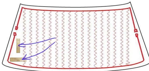
3. У некоторых автомобилей установлено стекло с атермальным покрытием (маркировка IR) – в этом случае с большой вероятностью метка будет экранироваться и не читаться считывателем. В данном случае необходимо разместить метку в «коммуникационном окне» (обычно за зеркалом заднего вида), оно выделено нанесенной на стекло сеткой.
